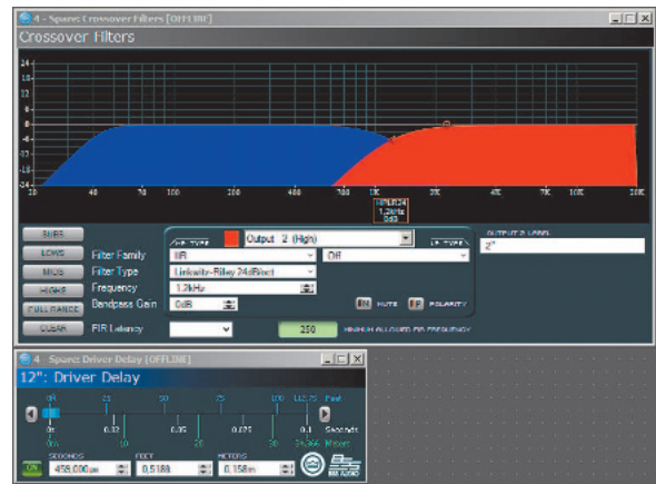
Filter Einstellungen für die Crown I-Tech HD Endstufe, Parameter für den Tieftöner hier in blau und für den Hochtöner in rot (Abb. 4)
