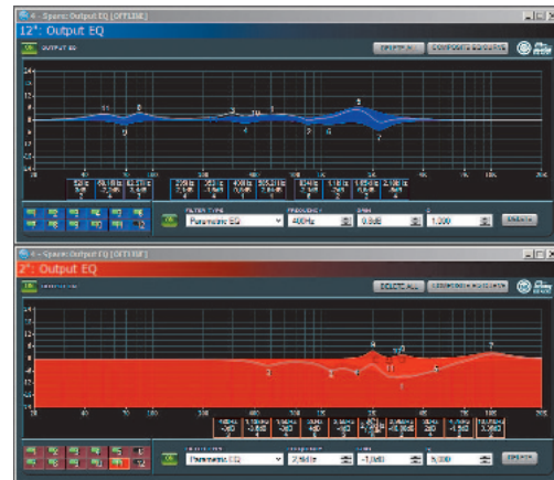
Filter Einstellungen für die Crown I-Tech HD Endstufe, Parameter für den Tieftöner hier in blau und für den Hochtöner in rot (Abb. 4)
